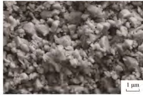
图 1 PZT 粉体 XRD 谱与微观形貌 SEM 照片 Fig. 1 XRD pattern and SEM image of PZT powder
